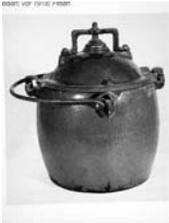
Meist Metallausführungen (Gußeisen, Aluminium) von Töpfen mit druckfest verschließbarem Deckel und Druckventil
