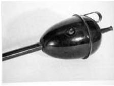
Sauggefäß mit Vorratsbehälter (kugel- bis tonnenförmig) im oberen Bereich und langem Saugrohr (Glas, emailliertes Eisenblech; Reinartz, Abb. 1533)
