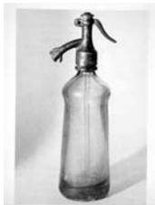
Zylindrische bis kugelförmige Flaschenform mit besonders konstruiertem Pump-Druck-Verschluß (bzw. Einsatz für Kohlensäurepatrone); besonders dickwandiges Glas, oft mit Drahtgeflechtmantel; rezent auch aus Edelstahl
