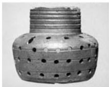
Dickwandige, stark gelochte Topfform mit deutlichem Halsansatz. - Diese Gefäßform, aus Steinzeug, Kupfer, Messing/Bronze etc. bekannt, diente zum Abtrennen grober Bestandteile beim Saugen des Löschwassers mit Schläuchen aus Teichen usw.
