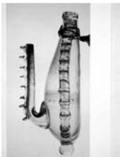
Hochovale geschlossene Glasflaschenform mit langem, aufsteigendem Rohranschluß; die Höhe des Wasserspiegels gibt den Luftdruck an.
