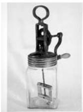
Faßform mit besonderem Aufsatz, der zentral eine rahmenartige oder plattenförmige Rührereinrichtung enthält, die um eine vertikale Achse bewegt wird (ältere Formen: Daubentechnik)
