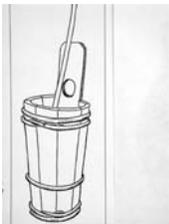
Meist hoher konisch/zylindrischer Topf mit Deckel und Spezialeinsatz (perforierte Platte/Rahmen), der vertikal an einer Achse auf und ab bewegt wird (Daubentechnik, Vollholz, Irdenware, Steinzeug, Braungeschirr).
